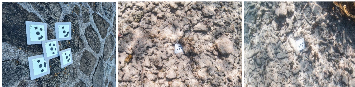
Figure 8. GCP – Points de contrôle positionnés sur le site d'étude
